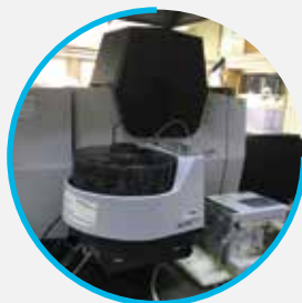
Espectrofotometro de absorción atómica para determinación de metales en alimentos, efluentes, fertilizantes y minerales
